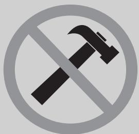
Non deve essere usata una forza eccessiva per montare il disco freno con cuscinetto preassemblato. Il disco deve essere posto sul mozzo a mano per salavaguardia il funzionamento del cuscinetto ruota.
