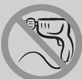
Die Muttern an der Nabe müssen mit einem Drehmomentschlüssel angezogen werden. In keinem Fall dürfen Schlagschrauber verwendet werden.
