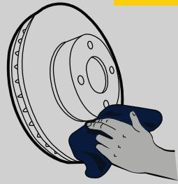
Ziehen Sie nach dem Einbau alle Schrauben gleichmäßig mit einem Drehmomentschlüssel nach Vorschriften des Fahrzeugherstellers an. Sonst riskieren Sie einen Seitenschlag der Bremsscheibe, der nicht mehr zu beheben ist.
