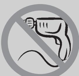
Les écrous sur le moyeu doivent etre serrés avec clé de serrage dynamométrique. N'utiliser jamais clés à percussion.
