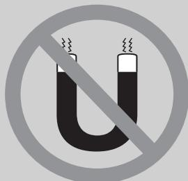
La bague magnétique du disque de frein ne doit pas etre posé près d'un champs magnétique, parce qu' on pourrait l'abimer et le rendre inutilisable.
